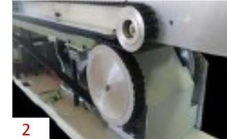
2 Cuando la temperatura está por debajo del límite prescrito, cuando detecta una falla, cuando la máquina está en modo de enfriamiento, además si una falla es detectada el movimiento de las bandas es en reversa hasta que la temperatura de operacion es alcanzada.
